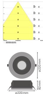
Technische Daten Ledvance LED Downlight Performance DN195 21W 2520lm 65D - 840 Kaltweiß | 220mm - IP54
