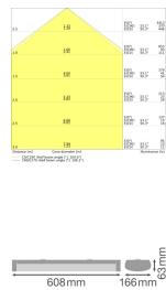
**Technische Daten Ledvance LED Feuchtraumleuchte 18W 2250lm - 830 Warmweiß | 60cm - 3 Stunden Notbeleuchtung**
