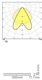
Technische Daten Ledvance LED Tragschiene Trusys Flex Klar Stahl Weiß 50W 8600lm 2x30D - 840 Kaltweiß | Dali Dimmbar
