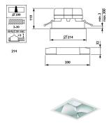
Technische Daten Philips LED Downlight LuxSpace Quadrat DN572B 20.9W 2600lm 80D - 830 Warmweiß | 214mm - Aluminium Reflektor
