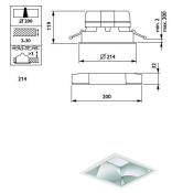
Technische Daten Philips LED Downlight LuxSpace Quadrat DN572B VLC-E 20.9W 2600lm 80D - 830 Warmweiß | 214mm - Aluminium Reflektor - Dali Dimmbar
